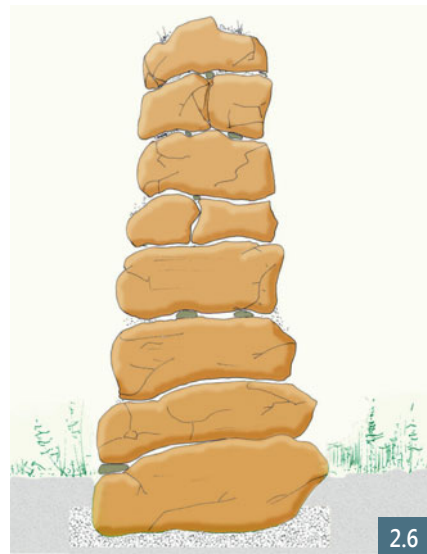
Obr. 2.6 Zeď se dvěma čely (jednotěnná) jako volně stojící zeď
