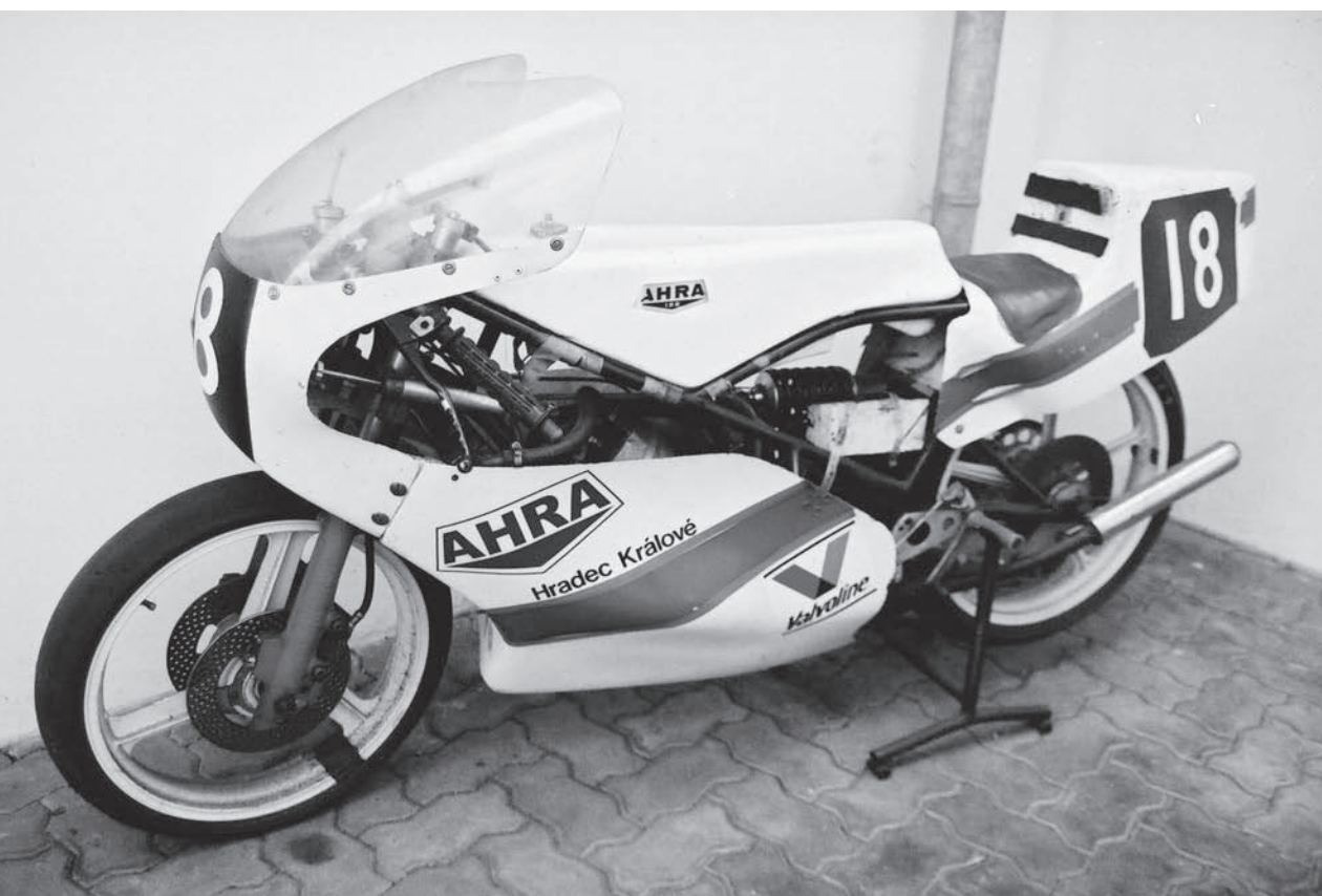
Poslední Ahra 125 s kotoučovými brzdami, paprskovými koly a odpružením Cantilever
