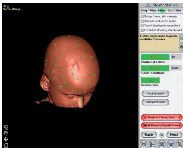
Obr. 1.34 Registrace navigačního systému pomocí snímání povrchových bodů (surface merge). Patrné rozmístění bodů na povrchu navigační vytvořeného modelu. Registrační chyba v tomto případě byla 0.5mm při použití 42 náhodných povrchových bodů
