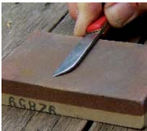
Obr. 1.2 Nůž ostříme tahem po povrchu mokrého brousku
