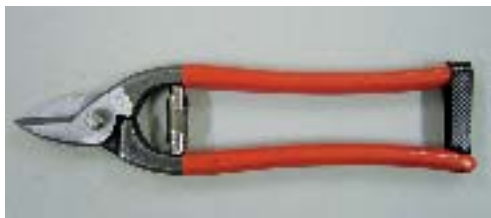
Obr. 1.4 Nůžky na drát s krátkým ostřím. Levákům se s nimi obtížně pracuje
