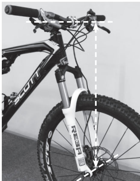
Obr. 7 Vzdálenost osy předního kola a středu řídítek
