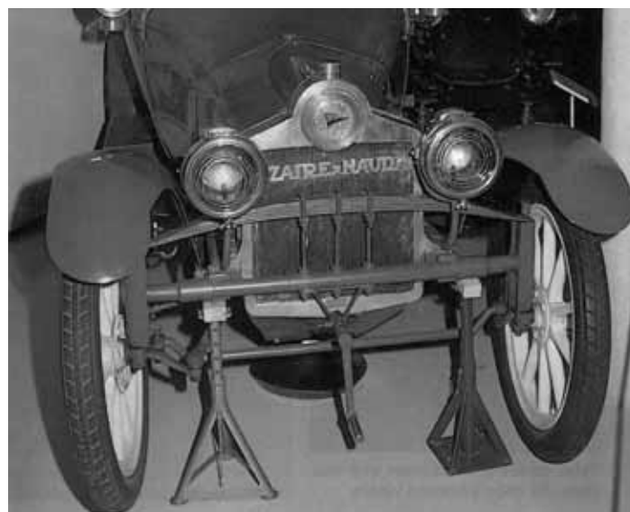
Obr. 1.13 Nezávislé odpružení přední nápravy vozu Sizaire-Naudin
