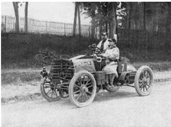
Obr. 1.2 Vítěz Poháru Gordon Bennetta v roce 1901, Léonce Girardot na čtyřlitrovém Panhard-Levassoru o výkonu 18 kW (24 k)
