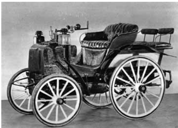
Obr. 1.1 Panhard-Levassor s dvouválcovým motorem do V Daimler z let 1893–1894 ze závodu Paříž-Rouen, ještě s řízením pákou. Ta byla nahrazena volantem až v roce 1898
