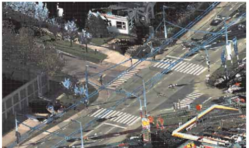
Mračno laserových bodů, lokalita Brno-Líšeň. Data jsou pořízena společně s panoramatickými snímky. K bodům se zaznamenává jejich přesná poloha a intenzita odrazu, obarvení skutečnými barvami je dáno následným zpracováním na počítači.
