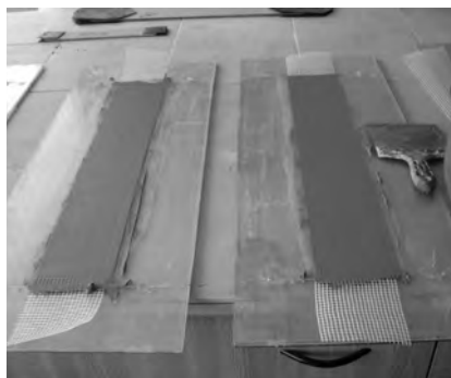
Obr. 14 Perlínka – příprava vzorků skleněné síťoviny k testu
