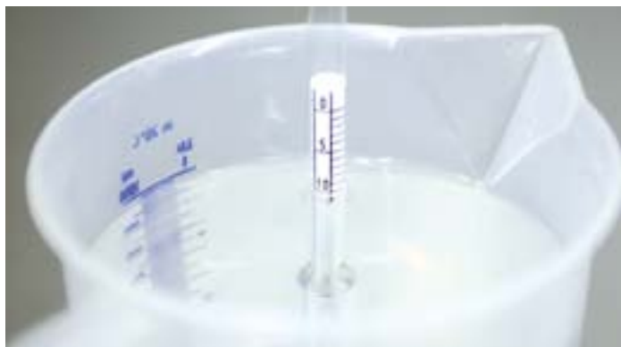
Stupnice na hustoměru ukazuje hustotu láku.
