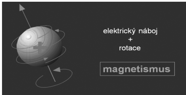
Obr. 1.2 Magnetické vlastnosti protonů jsou dané nábojem a rotací (Philips, 2002, 2003)
