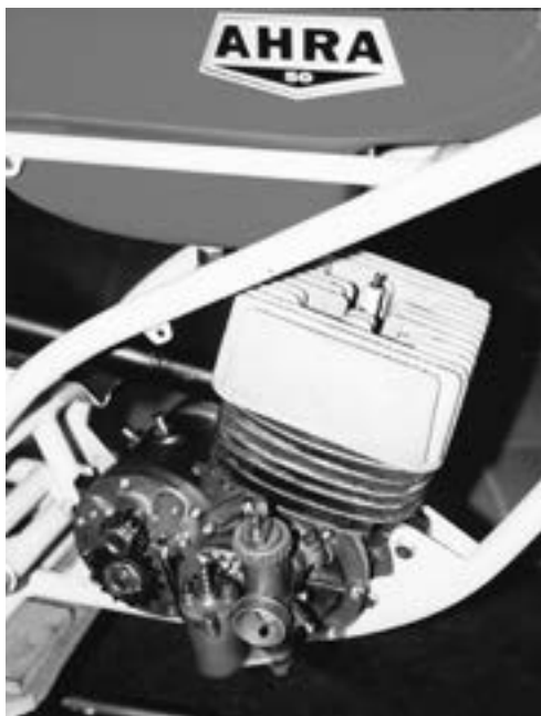
Detail vzduchem chlazeného jednoválce Ahra 50
