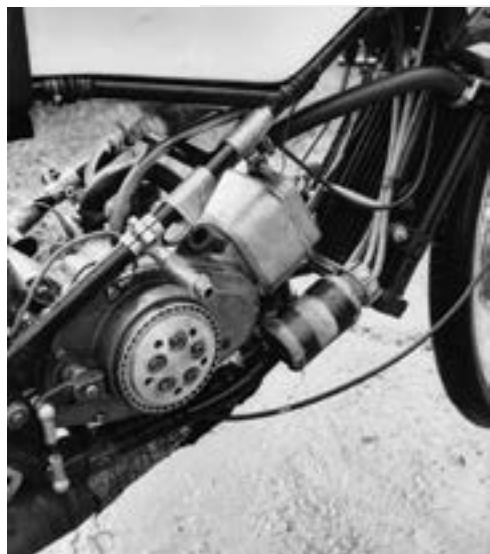
Oboustranný pohled na kapalinou chlazený motor jednoválce Ahra 50
