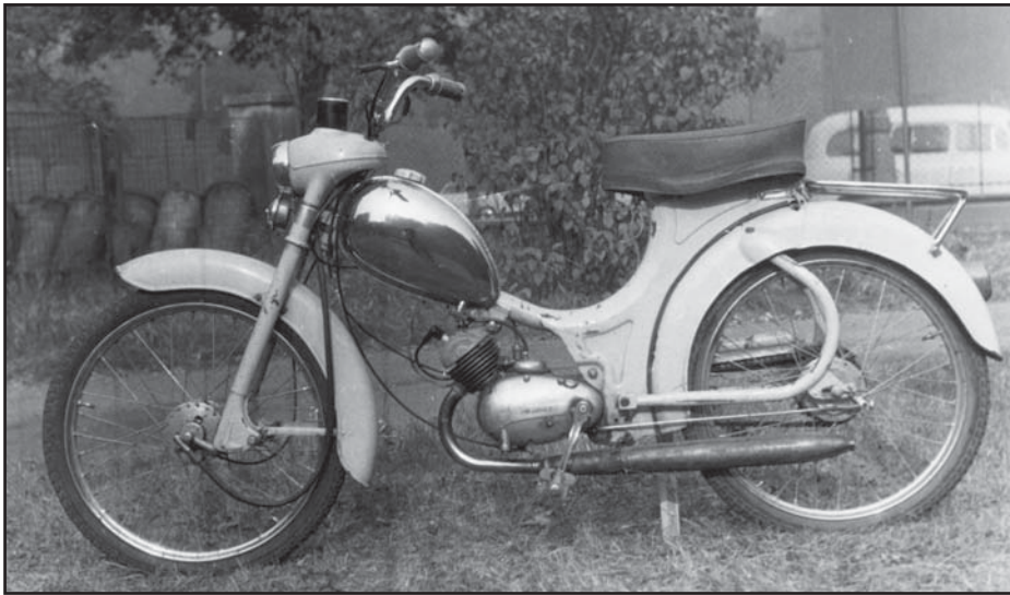
Prototyp č. 01, který dostal lakování ve světle šedobéžové barvě. Pro přesný záznam ujetých zkušebních kilometrů měl namontován motocyklový tachometr o průměru 60 mm, který provizorně trčel před řídítky, protože se nevešel do otvoru v masce reflektoru.
