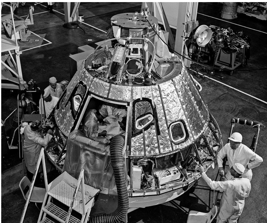
Velitelský modul lodi Apollo 1 před montáží tepelného štítu
