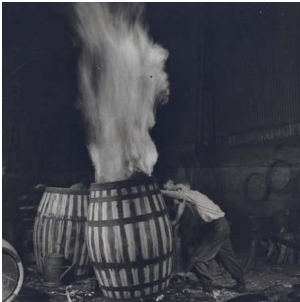
Sudy se před použitím vysmolovaly či vypalovaly. Důvodem byla potřeba jejich utěsnění a desinfekce. Samozřejmě to ovlivnilo chuť piva. Po několika použitích se tato úprava obnovovala. Byla to velice nebezpečná a namáhavá práce. Na snímku je zachyceno vypalování sudu v pivovaru Guinness v roce 1948.
