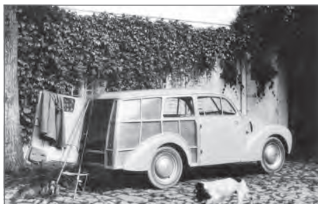
Aero Minor STW s viditelnou dřevěnou kostrou zadní partie karoserie
