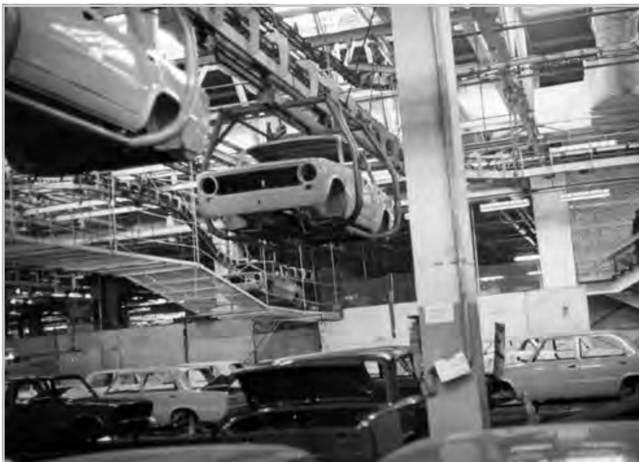
Výrobní linka automobilky VAZ postavená podle západního vzoru
