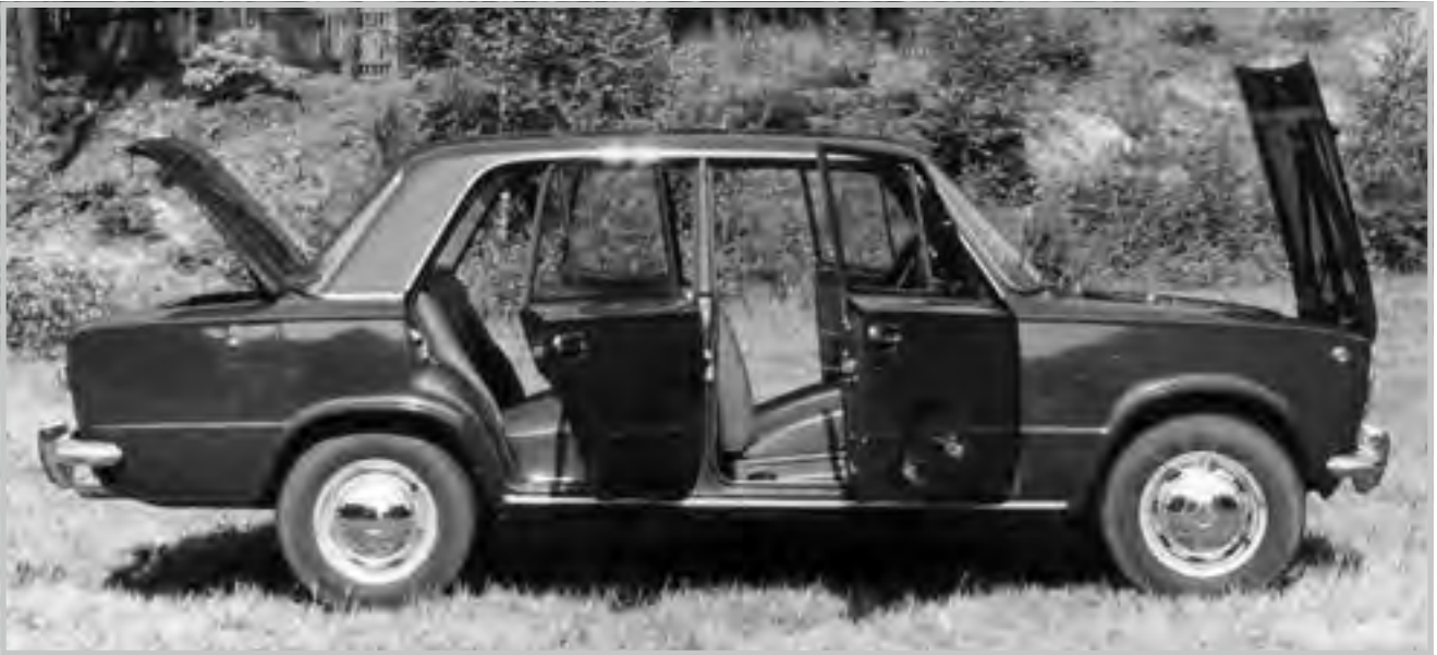
Víko motorového prostoru se odklápělo směrem kupředu
