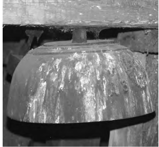
Obr. 5 Bronzový čtvrtový hodinový cimbál nejčastějšího tvaru
