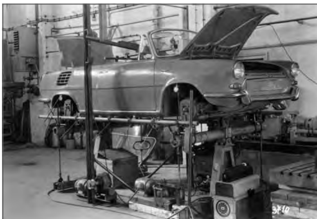
Karoserie Š 991 při tensometrických zkouškách
