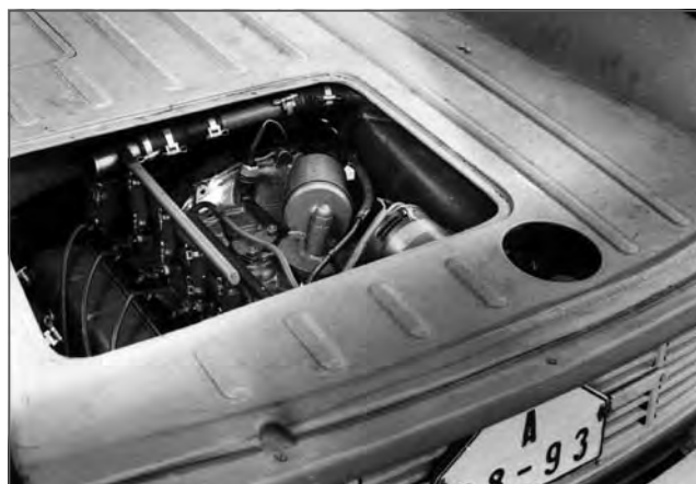
Přístup k ležatému motoru nebyl snadný
