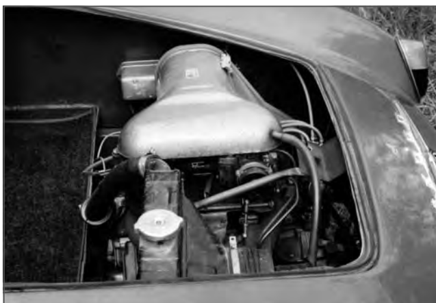
Před motorem byla plošina na zavazadla
