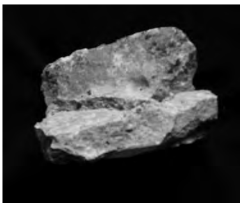
■ Litá štuková podlaha – estrich, dobře patrné dvě vrstvy (sv. Michael, Hildesheim, 12.stol.)
