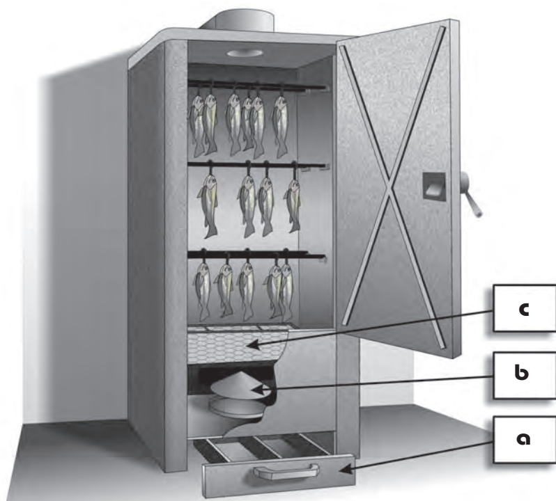
Obr. 5 Moderní udírna – udicí skříň z nerezové oceli a) prostor pro spalování udicí směsi b) rozvaděč kouře c) kouřový filtr a zároveň síť pod rybami proti pádu částí masa
