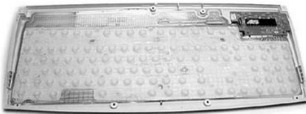
Obrázek 3.4a Ukázka klávesnice se spínači typu gumová „klenba“ (celek)
